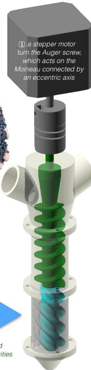
① uno stepper motor gira la vite di Auger, che a sua volta tramite un asse eccentrico aziona la vite di Moineau
