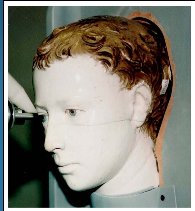
External PIXE analysis of the “Ritratto di fanciullo” by Luca Della Robbia – before restoration at the Opificio delle Pietre Dure in Florence
