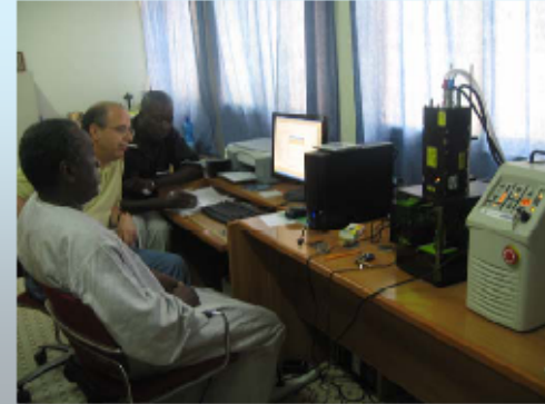
Figure 3 Dispositif expérimental LIBS 2500 Ocean Optics au Laboratoire Atomes Lasers de l'UCAD
