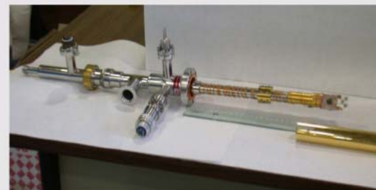
Dispositivo experimental para medidas de variación de resistividad inducida por radiación con la temperatura. Muestras de Fe de 60 \mu m irradiadas con H^+ 6 MeV en criostato
