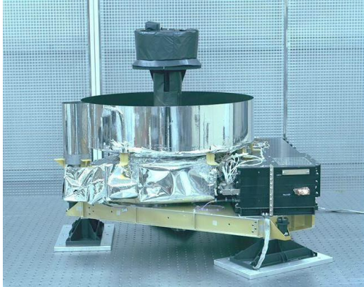
MOLA Mars Laser altimeter (USA, 1996)
