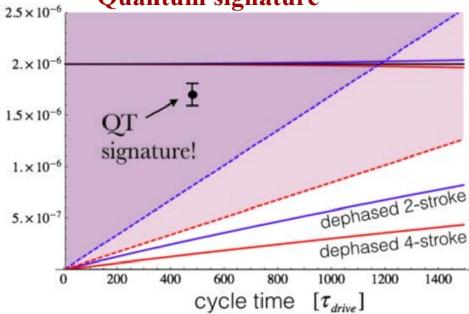
$$P_{\text{stoch}} \leq \frac{z}{8\hbar^2} \sqrt{\text{tr}(H_0^2) - \text{tr}(H_0)^2} \Delta_w^2 d^2 \tau_{\text{cyc}},$$
