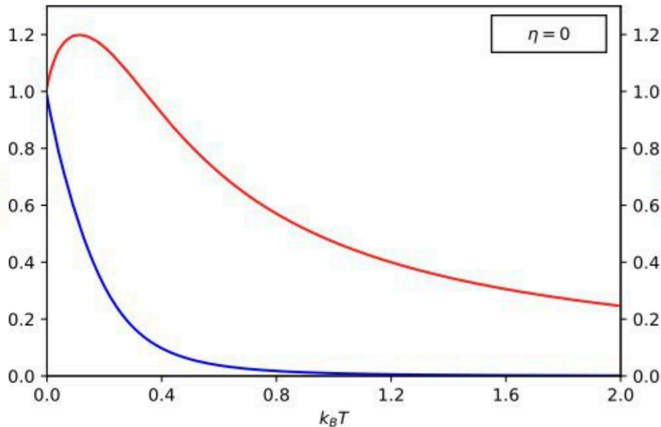
$$\begin{cases} J_c \simeq \frac{4e\Delta_0}{\hbar} (1 + |\Gamma(\theta_V, \theta_\Phi)|) & \text{for } k_B T \ll \Delta_0 \\ J_c \simeq \frac{4e\Delta_0}{\hbar} \frac{\Delta_0}{2k_B T} |\Gamma(\theta_V, \theta_\Phi)| & \text{for } k_B T \gg \Delta_0 \end{cases}$$
