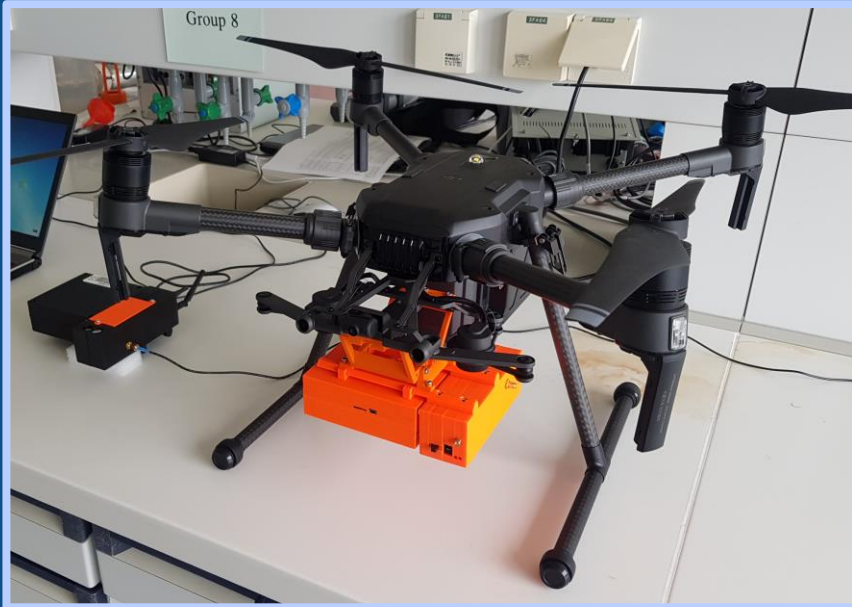
UAV DJI Matrice 210 V2 Commercial GS Module 1x1" SiPM NaI(Tl)
