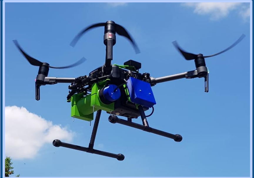
UAV DJI Matrice 210 V2 Experimental GS Module 2x2" NaI(Tl) & 1.5x1.5" SiPM CeBr3
