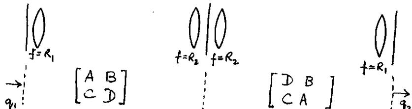
$$\text{overall ray matrix} = \begin{bmatrix} D & B \\ C & A \end{bmatrix} \begin{bmatrix} A & B \\ C & D \end{bmatrix}$$
