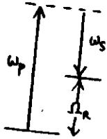
$$\hbar\omega_s = \hbar\omega_p - \hbar\Omega_R$$
