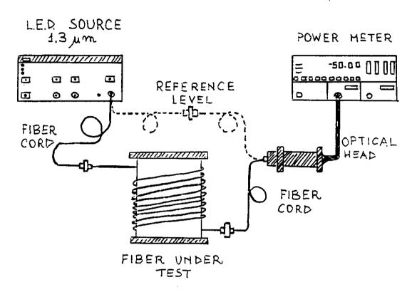
TRAHSMITTER: L.E.D. SOURCE (λ=4.3 μm ,Δλ=60 nm)
