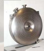
Cavité ré-entrante (Legnaro) 352 MHz - \beta \geq 0,1
