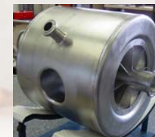
Cavités spoke (CNRS Orsay) 352 MHz - \beta = 0,15 et 0,35
