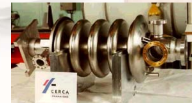
Cavité APT (Los Alamos) 700 MHz - \beta = 0,64
