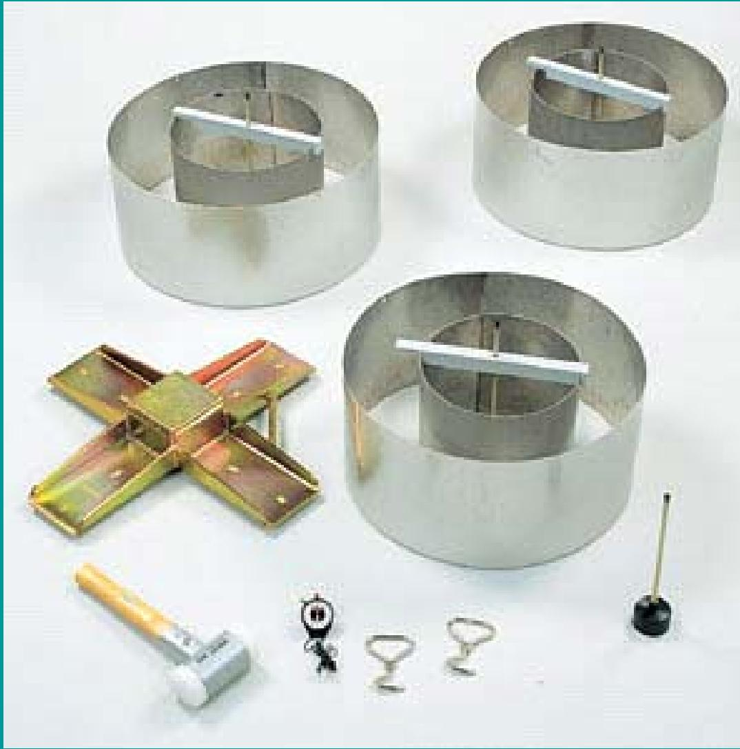
El infiltrómetro de doble anillo es un sencillo instrumento utilizado para determinar la velocidad de infiltración del agua en el suelo. Esta es la cantidad de agua que penetra en el suelo desde la superficie por unidad de área y de tiempo.
