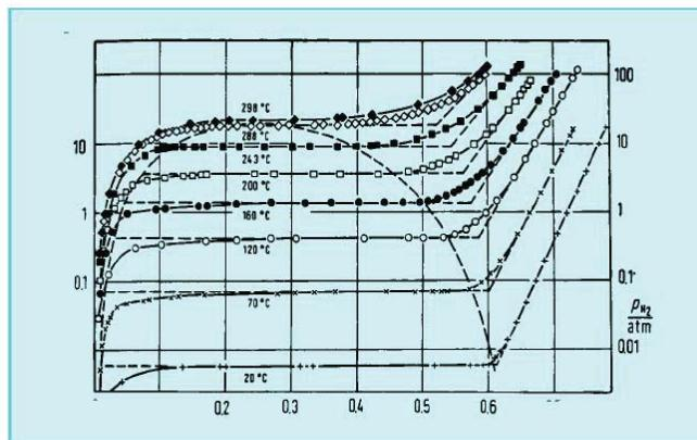
Diagramme d'état Composition-Pression à différentes températures du système palladium-hydrogène. La courbe de décomposition spinodale est clairement préfigurée par l'ensemble des isothermes.
