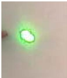
Sección de puntero láser verde después de propagarse 1 m.
