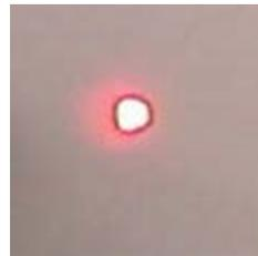
Sección de puntero láser rojo después de propagarse 1 m.
