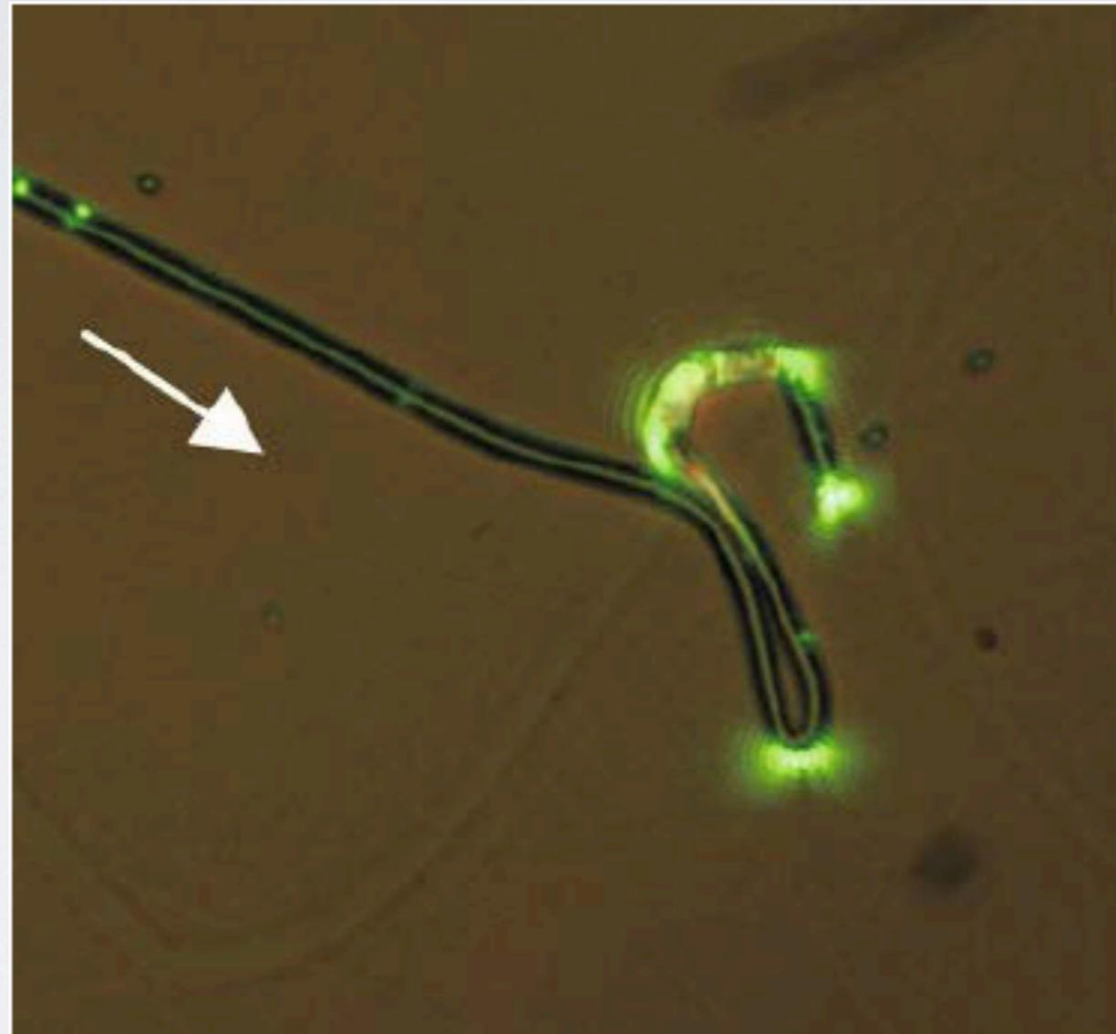
Fibra óptica con un diámetro de  $500 \text{ nm}$  propagando luz de  $532 \text{ nm}$  a través de un radio de curvatura de  $1.5 \mu\text{m}$  de radio.
