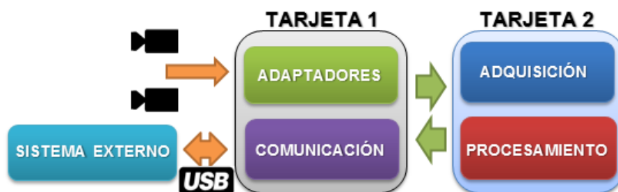
Figura N2. Diagrama del hardware propuesto
