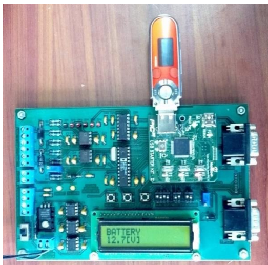
Figura. 12. Data Logger para Inclínometría (TILTLOG: Diseño desarrollado por Roberto Carlos Toapanta).
